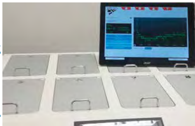
Figura 2: Incubadora tipo mesa ( bench top ) con control de pH continuo.
