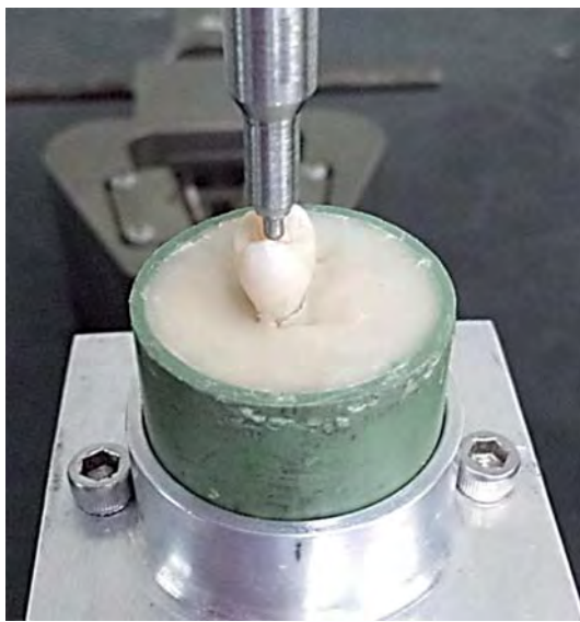
Figura 1. Carga compresiva a los especímenes en la máquina de pruebas mecánicas universal (MTS® Alliance RT/30).
