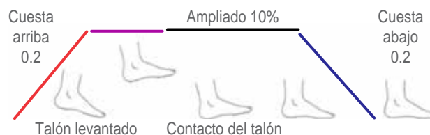
Figura 3: Parámetros para la marcha del equipo inalámbrico estimulación eléctrica funcional.
