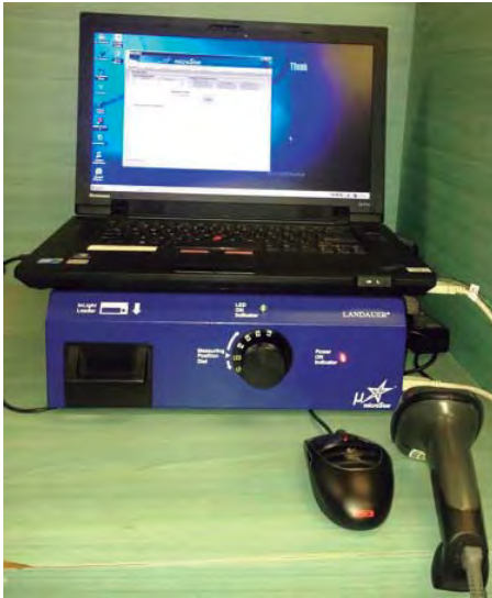
Figura 3. Equipo de software Microstar® Reader para lectura de los dosímetros de tecnología OSL.
