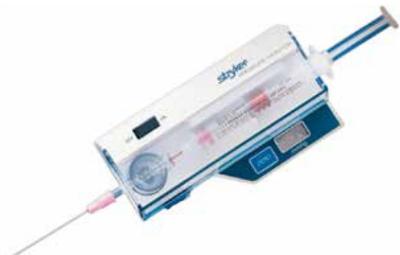
Figura 2: Imagen del dispositivo para medir la presión dentro del compartimiento muscular denominado intra-compartmental monitor pressure system de la marca Stryker®. Imagen obtenida a partir de la página: https://pdf.medicalexpo.com/pdf/stryker/intra-compartmental-pressure-monitor/70192-169461.html
