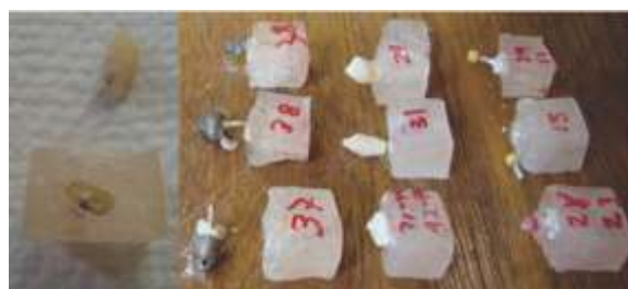
Fotografía 5. Muestras sometidas a la fuerza de compresión lateral que provoca fractura a nivel del tercio cervical, con el desalojo del poste.
