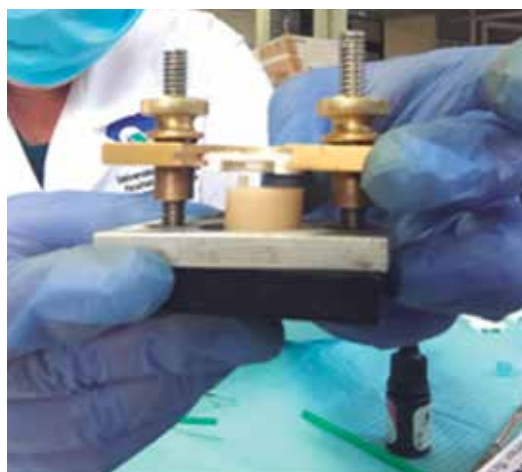
Figura 4. Muestra el aditamento y cilindro obtenido de resina compuesta.
