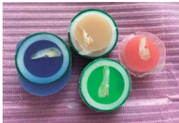
Figura 3. Muestra los tubos de propileno necesarios para suspender las probetas.
