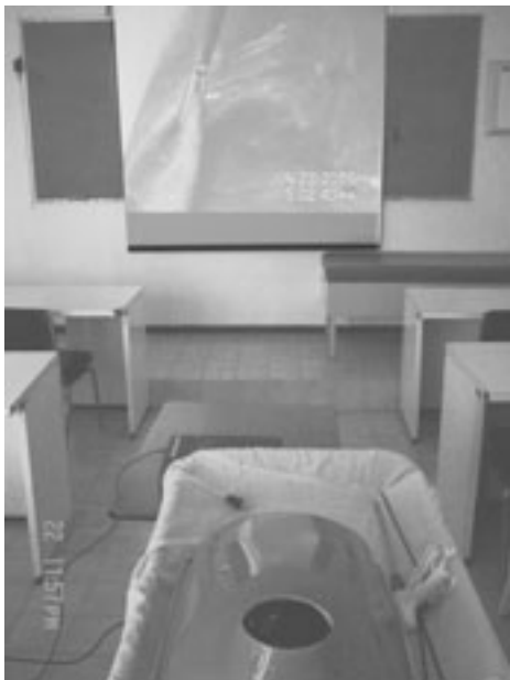
Figura 1. Maniquí antropomorfo de fibra de vidrio, rígido, radiolúcido, impermeable y no conductor, que incluye tronco y abdomen.
