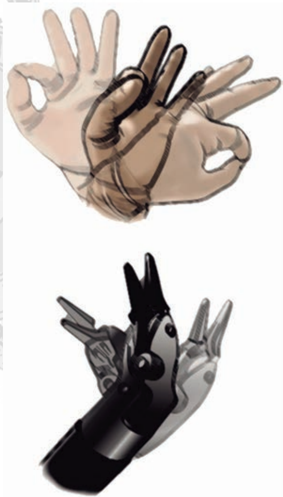
Figura 1. Tecnología Endowrist®. Los efectores de la plataforma robótica DaVinci® (Quirúrgicamente Intuitiva), replican los movimientos de la mano humana y permiten la manipulación quirúrgica precisa e intuitiva.
