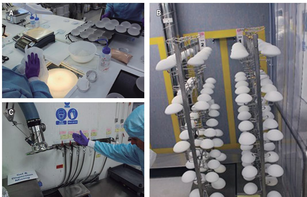
Figura 1: Proceso de fabricación de los implantes mamarios.
