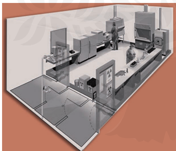
Figura 4. Laboratorio típico del nivel de bioseguridad 3. (Ilustración amablemente cedida por CUH2A, Princeton, NJ (EE.UU.)). El laboratorio está separado de la circulación general y se accede a él por un vestíbulo (entrada de doble puerta o laboratorio básico – nivel de bioseguridad 2) o una cámara de cierre hermético. Dentro de la sala se dispone de una autoclave para la descontaminación de residuos antes de su eliminación. Hay también un lavabo con grifo que puede accionarse sin usar las manos. La corriente de aire circula hacia el interior y todo el trabajo con material infeccioso se efectúa en una cámara de seguridad biológica.
