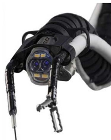
El extremo distal flexible del robot que incluye dos canales de trabajo con un cuchillo de aguja y una pinza.
