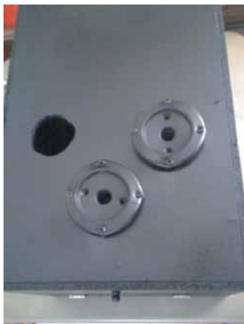
Figura 3. Orificios y la colocación de embudos para los trócares.
