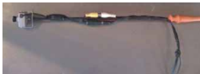
Figura 4. Cámara de seguridad unida a un instrumento monopolar de corte desechable, la cual simula una cámara laparoscópica.
