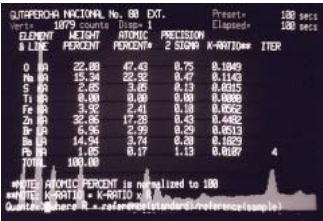
Figura 5. Microanálisis de espectroscopia de energía dispersiva de rayos X (EDX) de la superficie externa de cono de gutapercha PRODENT calibre No. 80.
