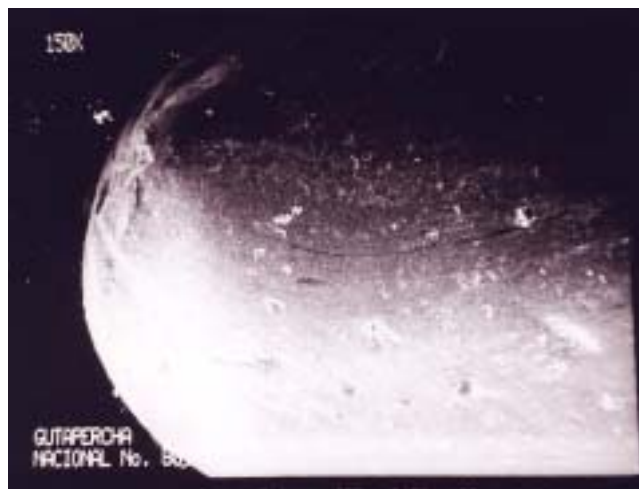
Figura 3. Superficie de un cono de gutapercha PRODENT en donde se observa la morfología homogénea, y libre de defecto.
