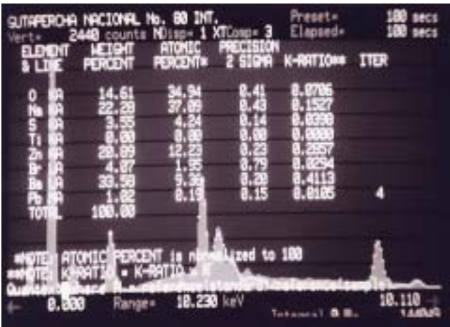
Figura 6. Microanálisis de espectroscopia de energía dispersiva de rayos X (EDX) de la estructura interna de cono de gutapercha PRODENT calibre No. 80.
