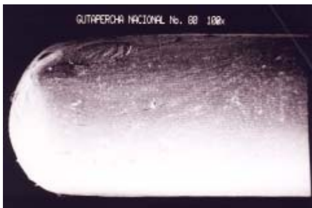
Figura 2. Superficie del D1 de cono de gutapercha PRODENT en donde se observa una morfología homogénea, punta bien redondeada, sin aristas y libre de defecto.
