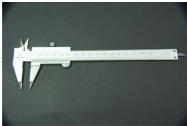
Figura 1. Instrumento de medición empleado (Vernier metálico con puntas afiladas).
