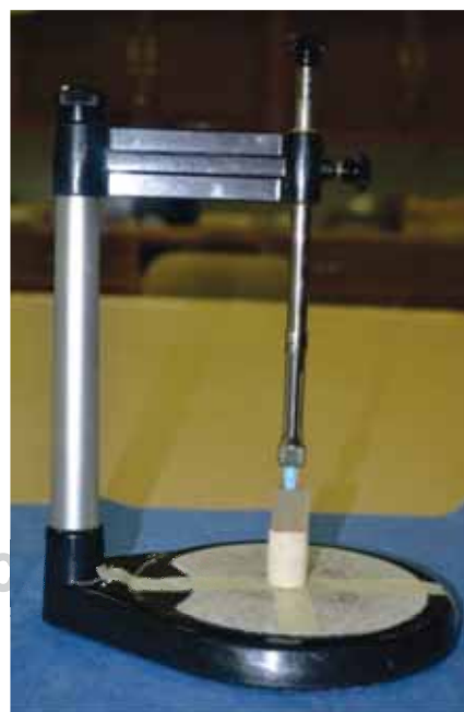
Figura 1. Modelo empleado para la simulación de inserción de agujas dentales bajo diferentes técnicas y calibres de agujas.
