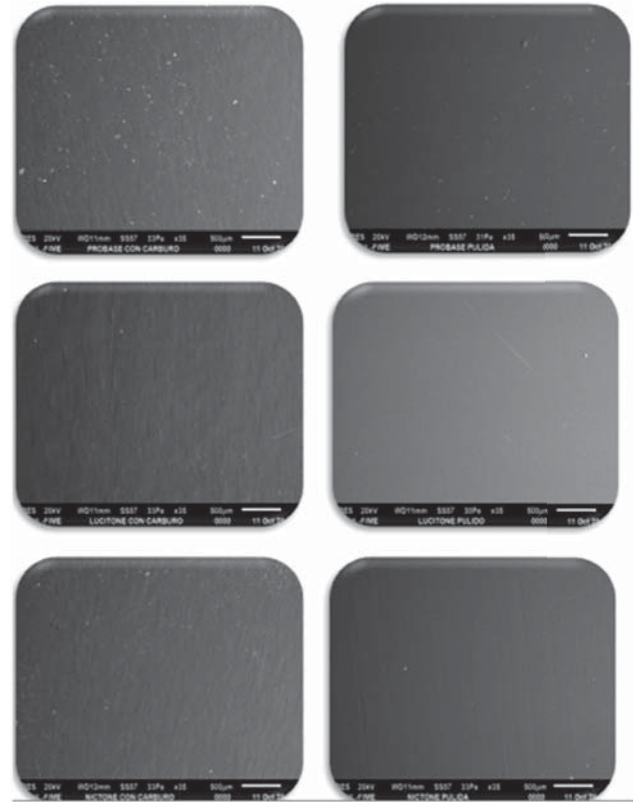
Figura 2. Izquierda: especímenes tratados con carburo; derecha: muestra pulida convencionalmente. Arriba: Especímen ProBase. Centro: Lucitone 199. Abajo: NicTone. (MEB 35X).
