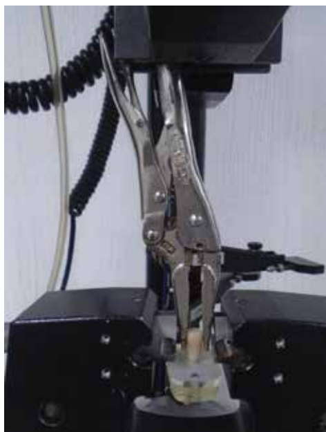
Figura 1. Imagen representativa de la ejecución de la pruebas de resistencia al desalojo en tensómetro universal.
