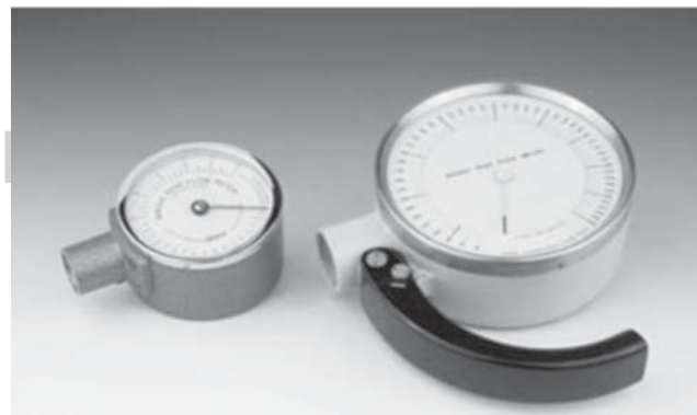
Figura 1. Primer flujómetro. Introducido en 1950 por Martin Wright.
