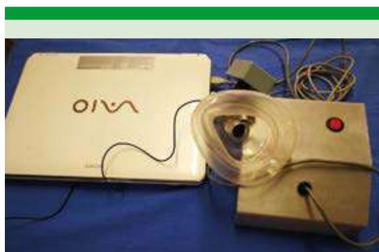
Figura 1. Sensor de presión marca Honeywell®, acoplado a una mascarilla para anestesia Sure Seal®.
