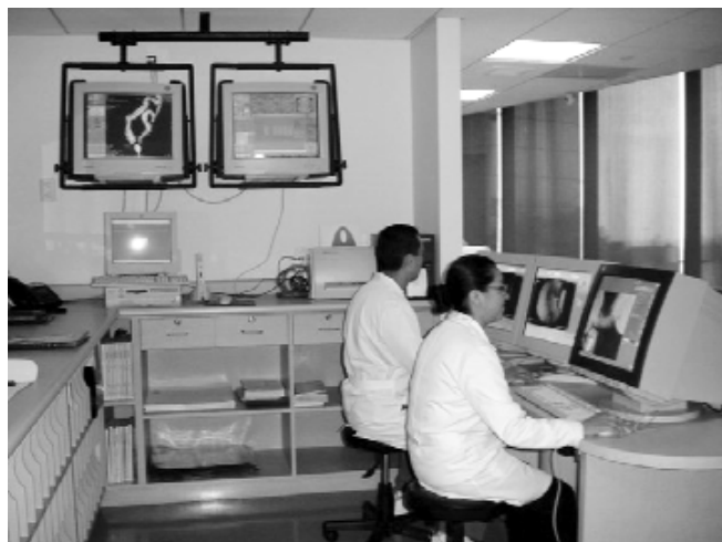
Figura No. 2. Área de control de calidad en la que el médico radiólogo dispone de izquierda a derecha de una terminal del RIS, un juego de monitores de 1.7 K del PACS y un monitor de control de calidad del sistema de digitalización de rayos-X (CR).
