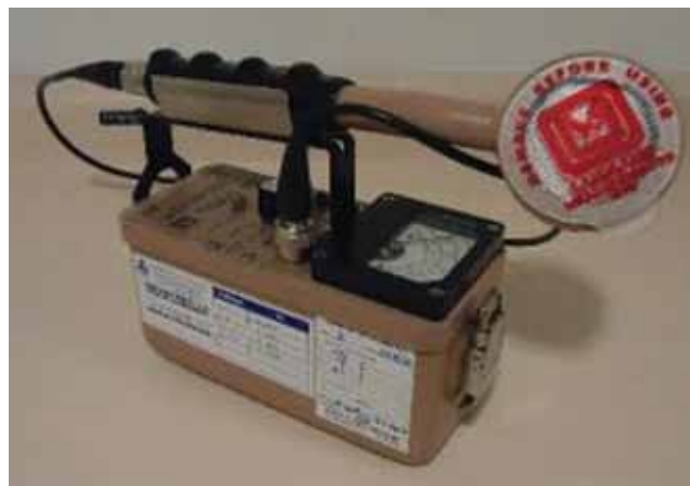
Figura No. 9. Detector y monitor de radiación Geiger Müller tipo pancake .
