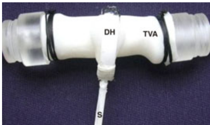
Fig. 3. Posición de un dispositivo hidráulico (DH) en el tronco vascular artificial (TVA) para obtener su comportamiento a diferentes presiones. S: Conector de silastic (Ver texto).
