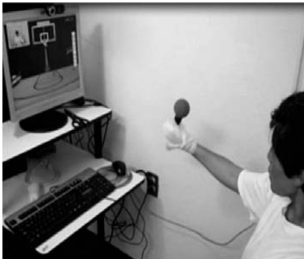
Figura 1. Sistema Gesture Therapy , la imagen muestra la colocación del paciente frente al sistema de cómputo, el diseño del joystick y cámara que realiza el seguimiento de los desplazamientos que realiza el paciente.
