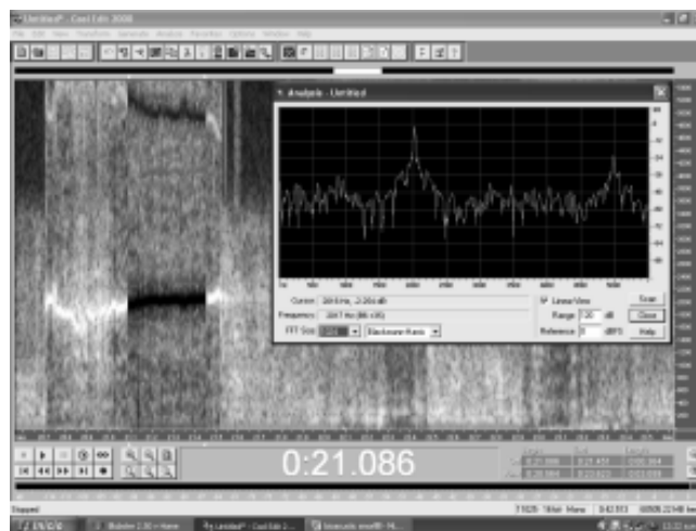
Figura 2. El software Cool Edit permite obtener los valores de la frecuencia fundamental (F0) y de los armónicos o formantes al descomponer la onda de sonido mediante el análisis de Fourier. Se observa en el análisis espectrográfico de la vocalización de rata que sobresale una espiga, cuyo valor es el referente a la frecuencia fundamental (en este caso de 2,086 Hz). El análisis se logra al colocar el cursor en la punta de la espiga que es representativa de la F0 o de los armónicos, según sea el valor solicitado.
