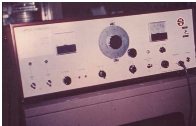
Figura 1. Modelo de Estroboscopio Nagashima de tipo indirecto que fue utilizado de 1973 a 1975.
