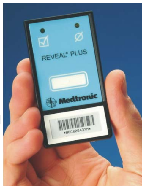
Figura 2. Activador externo portátil para almacenar episodios en modo manual.
