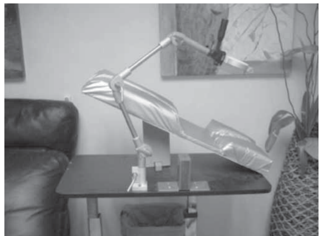
Figura 3. Tercer brazo diseñado, articulado en tres secciones con movimientos milimétricos en todos los ejes.
