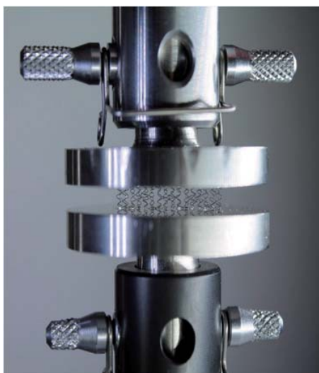
Figura 3. Prueba de compresión diametral en placas paralelas (ISO 25539-2).
