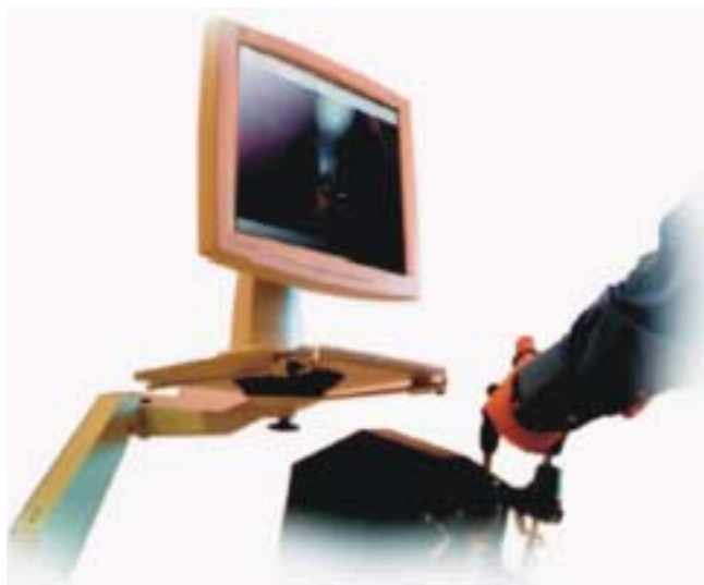
Figura 1. Cirugía simulada. Simulador quirúrgico para entrenamiento en colecistectomía. En el monitor se observan órganos e instrumentos virtuales. Cortesía de Pehr-Johan Fager. Reachin. Estocolmo, Suecia.
