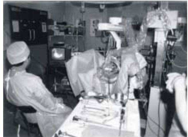
Figura 5. Cirugía semiautomatizada. Sistema robotizado para realizar resecciones transuretrales de manera automatizada bajo la supervisión del cirujano. Cortesía del Dr. Fernando Arámbula. Universidad Nacional Autónoma de México.
