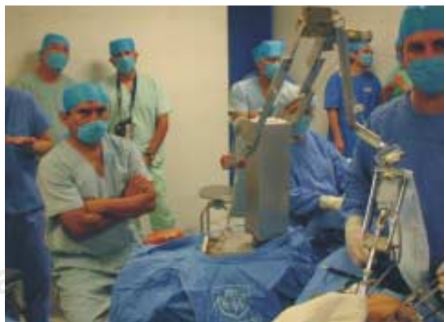
Figura 3. Cirugía asistida por un brazo robótico. Robot Tonatiuh, para sujetar y posicionar laparoscopios. Primer asistente del cirujano.
