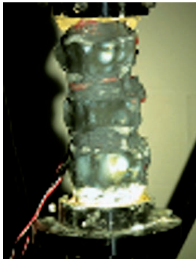
Figura 3. Vertebrales porcinas sometidas a carga de compresión y su análisis por fotoelasticidad y extensometría.
