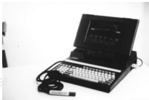
Figura 2. Sonda conectada a computadora portátil. La computadora interpreta la emisión de radiaciones gamma y los expresa en una figura numérica.
