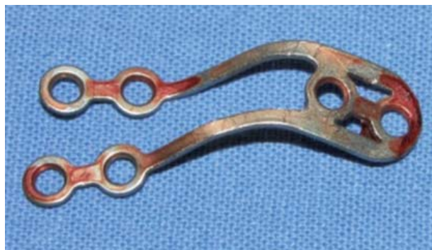
Figura 2. Placa sagital MODUS OSS 2.0 retirada después de cuatro meses de la operación del paciente. Nótese la forma de los brazos de la placa debido a la acción de los movimientos mandibulares y de la masticación, ya que esta placa al colocarse en su sitio el deslizador la contornea.
