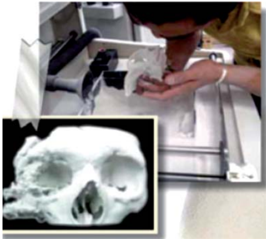
Figura 7. Impresora 3D ZPrinter 650-Z Corp, elaborando modelo de estudio.
