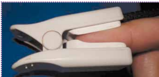
Fotografía 2. Colocación correcta del oxímetro.
