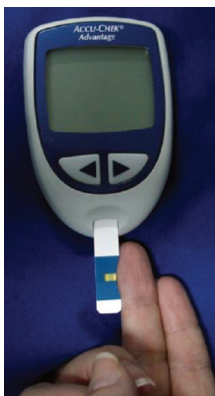
Fotografía 6. Colocación correcta de la tira.
