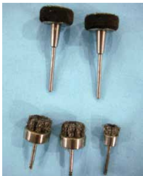
Figura 7. Fresas de alambre de acero de corte horizontal y vertical
