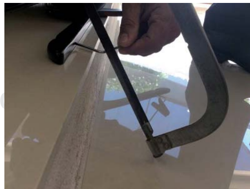
Figura 2. Cortando el extremo de la varilla de metal.
