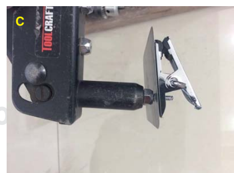
Figura 7. A) Se observa cómo atraviesa el remache sin problema la pinza y después el agujero de la lina; B) Se coloca la pinza sobre el remache, y C) Se fija la pinza sobre la lina.
