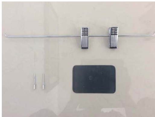
Figura 3. Material utilizado en el segundo paso. Se observa la longitud de la varilla con ambas pinzas y dos remaches tipo pop. (Opcional: Los ángulos de la lina se redondean con la finalidad de disminuir accidentes por punción.)
