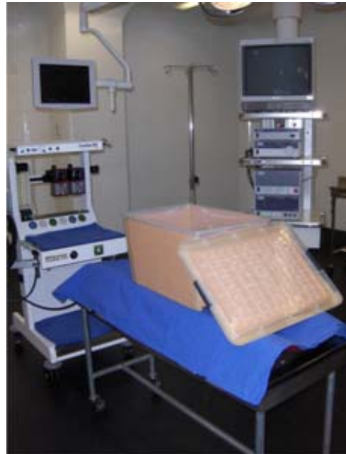
Figura 3. Tapa y paredes de la caja simuladora cubiertas con foamy.
