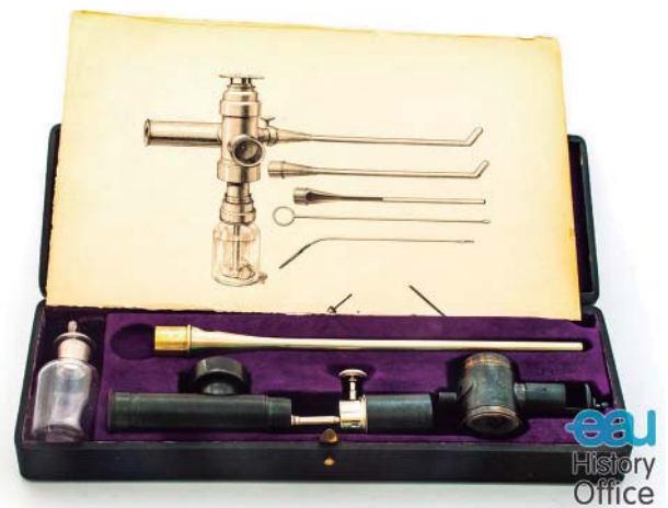
Figura 2. Diseño del primer «endoscopio» de la historia creado por Desormeaux en 1853 para el diagnóstico de patologías de uretra y vejiga. Ubicado en el European Museum of Urology .
