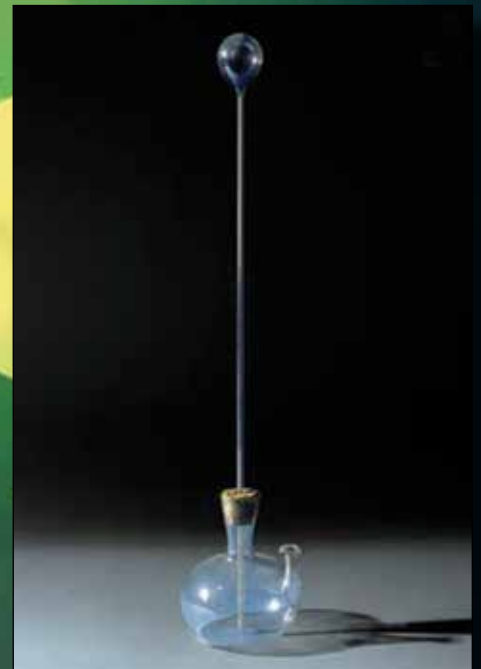
Termoscopio de Galileo.
