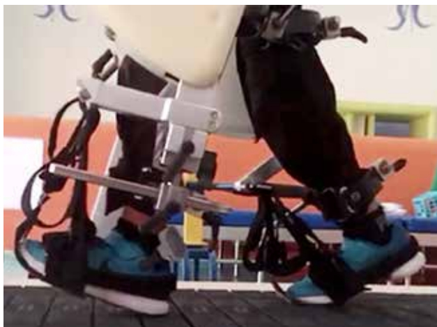
Figura 4: Uso simultáneo de ortesis robótica de la marcha y estimulación eléctrica funcional.
