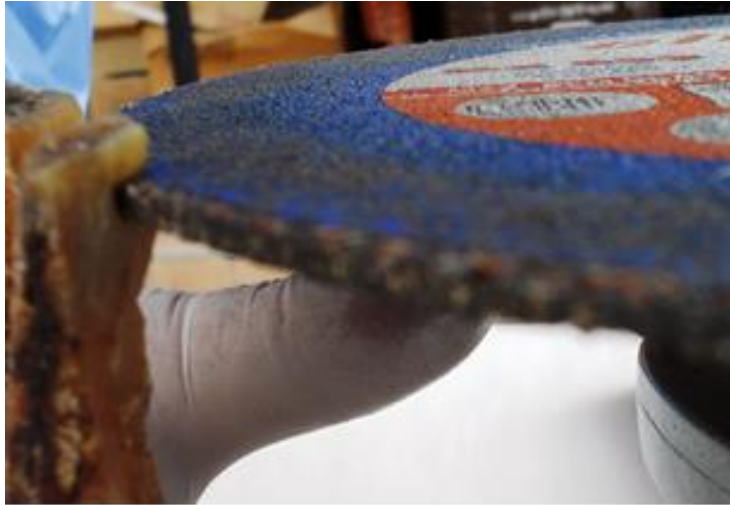
Figura 4. Prueba de comparación del instrumento empleado para el corte en tejido óseo y el borde de la hoja circular de un instrumento de alta velocidad (amoladora).
