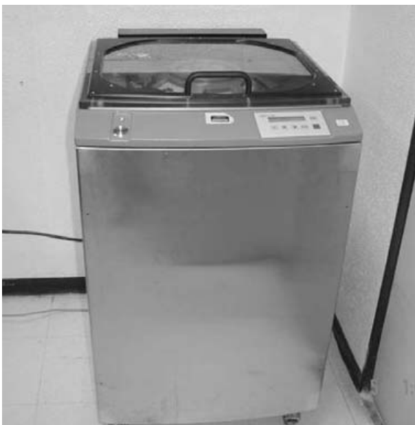
Figura 1. Prototipo de equipo Atreus para efectuar fraccionamiento automatizado de la sangre total.
