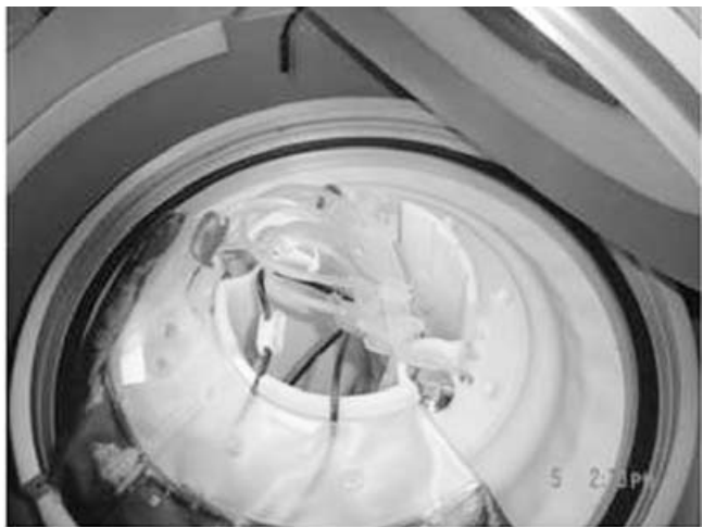
Figura 2. Colocación del sistema de bolsa estéril para el fraccionamiento automatizado de sangre total en el equipo Atreus.
