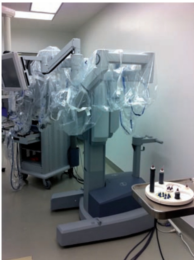
Figura 2. Unidad robótica con brazos, cubiertas de protección y modelo para prácticas simuladas.
