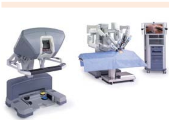
Figura 1. Sistema Da Vinci integrado por tres unidades operativas reunidas en una consola maestra, el robot esclavo por un sistema de procesamiento de imágenes.
