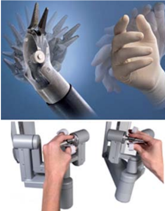
Figura 3. Instrumental robótico, similar al laparoscópico pero con un sistema de poleas.
