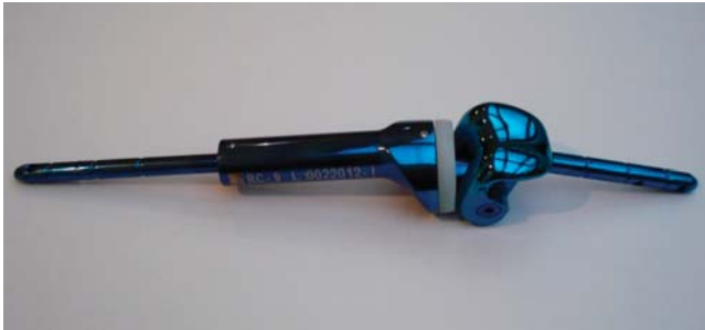
Figura 9: Imagen de la endopr3tesis tumoral tibial no convencional RC-9 de cuarta generaci3n, est3 manufacturada en titanio grado m3dico, con ambos componentes de una sola pieza, articulados por medio de un perno y bujes de polietileno de alta densidad, con un espaciador interno para darle longitud de hasta 8 cm, no cementada y bloqueada con pernos.
