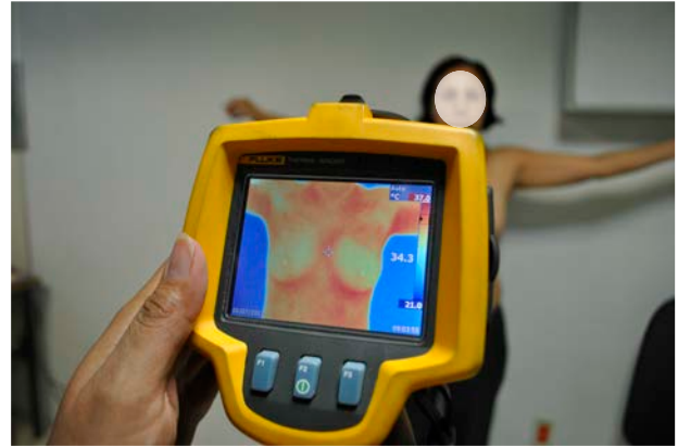
Figura 1. Concepto de medición termográfica en glándula mamaria. Se muestra la imagen termográfica de mamas de una paciente voluntaria obtenida con cámara termográfica Fluke Ti10.
