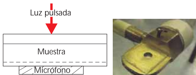
Figura 1. Celda fotoacústica. La luz incide en la muestra por la parte superior a través de una fibra óptica; el micrófono está situado lateralmente.
