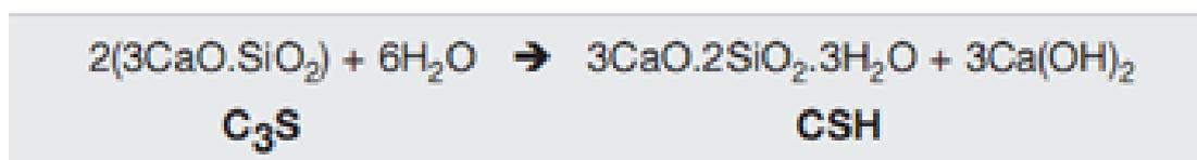
**Figura 2.** Reacción de hidratación del silicato tricálcico
